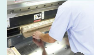
使用切割机将纸币精确切割成指定尺寸。
