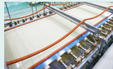
让“纸料”在网上薄薄地流动着,进行精巧的多层次水印(黑白水印),然后干燥并卷取。
