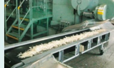
将用纸的原材料马尼拉麻纸浆,使用机器进行精细切碎。
