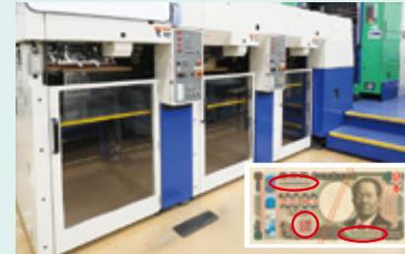
检查正反面的图案,表面的印章和由字母、数字组成的序列号码。
