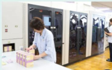
裁切好的纸币由机器逐张进行检查,确认纸币的数量并进行带扣操作,最终制成每1000张纸币为一捆。
