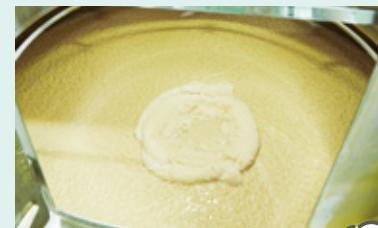
将纤维和化学药品混合会形成作为纸张基础材料的“纸料”。这些过程是通过中央管理装置进行控制的。
