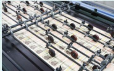
将版面放置到由国立印刷局开发的印刷机上,按照背面、正面的顺序进行图案印刷。由于胶版印刷和凹版印刷是同时并连续进行的,因此可以高精度地印刷细微的图案。
