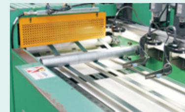
将卷取后的纸张切割成印刷所需的尺寸,然后送往下一个印刷工序。
