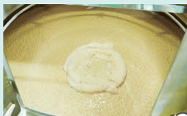
薬品と混ぜ合わせ、用紙の元となる「紙料」(しりょう)ができあがります。これらの工程は、集中監視装置により制御されています。
