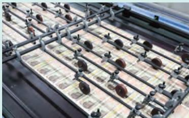
国立印刷局が開発した印刷機に版面をセットし、裏面、表面の順に図柄を印刷します。1台の機械でオフセット印刷と凹版印刷を連続して行うので、細かい模様を高い精度で印刷することができます。
