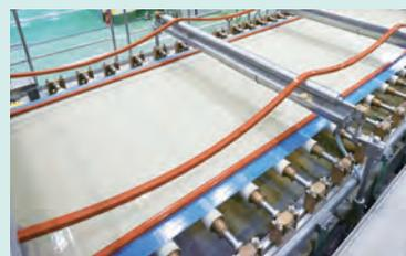
「紙料」を網の上に薄く流してすき、精巧なすき入れ(白黒すかし)を施し、乾燥させて巻き取ります。
