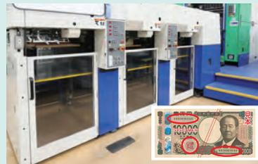
表裏の模様を検査し、表面の印章と、アルファベットと数字の組み合わせである記番号を印刷します。
