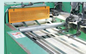
巻き取った用紙を印刷する大きさに切り分け、次の印刷工程に送られます。
