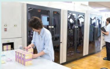
断裁されたお札を機械で1枚ずつ検査し、枚数確認と帯かけを行い、1000枚ずつの束に仕上げます。
