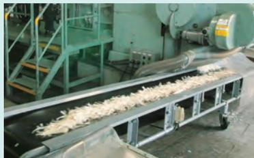
用紙の原材料となるアバカパルプを機械で細かく刻みます。
