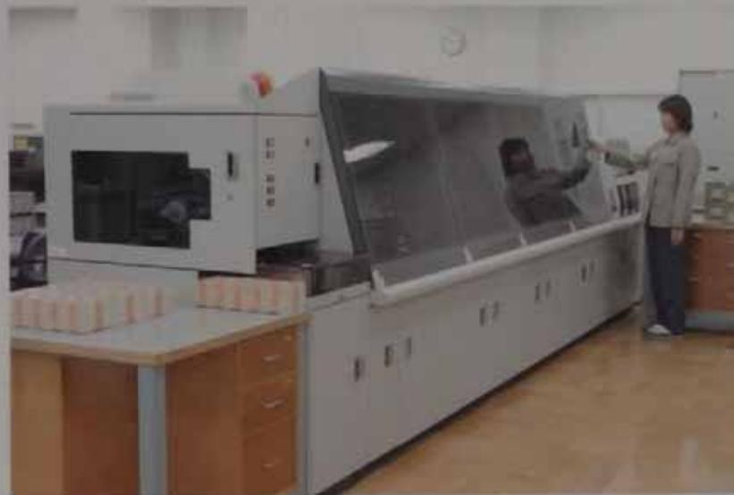
断裁されたお札を機械で検査し、枚数確認、帯かけなどを行い、千枚束に仕上げます。
