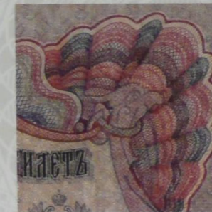
オルロフ印刷 3~4つの部分版にそれぞれ異なる色のインキを付け、彩紋図柄の凸版面に集合して印刷する。 ロシア政府紙幣(部分) 1905年
