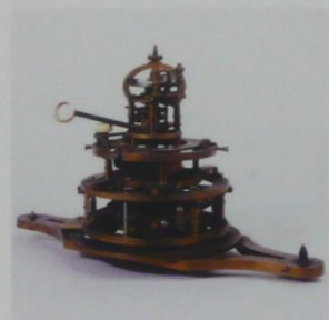
©Collection of The New-York Historical Society スペンサーの彫刻機を改良した初期の彩紋彫刻機 サイラス・デュランド製作 アメリカ 1823年
